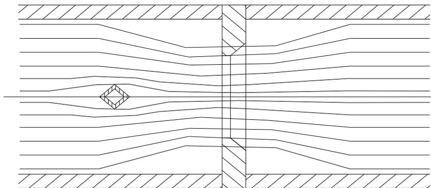
均速管与孔板在被测管道中造成的压力损失对比示意图
