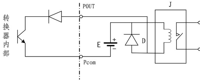
图 4.5 (c) 数字量输出接继电器
