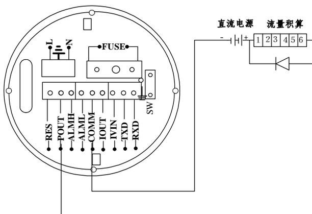
图 4.4.2 (b) 电磁计数器接线
