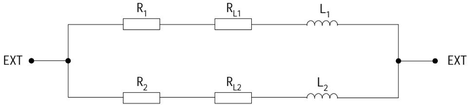
(4) 传感器励磁电流稳定时间过长（电感量过大）
