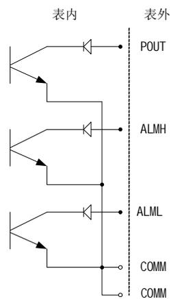
图 4.4.2 (e) 表内 OC 门连接方式
