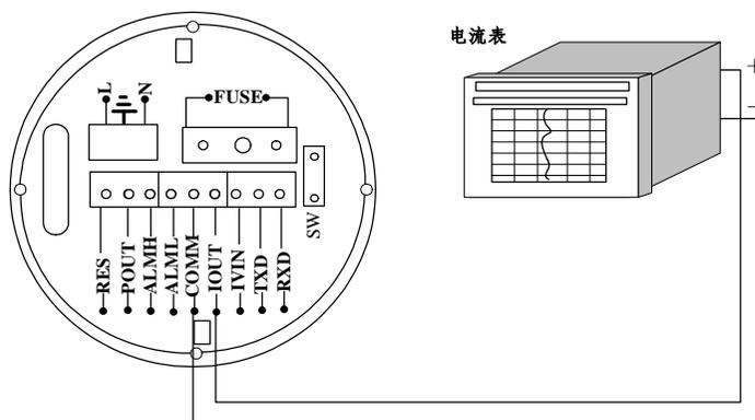
图 4.4.2 (a) 电流输出接线图
