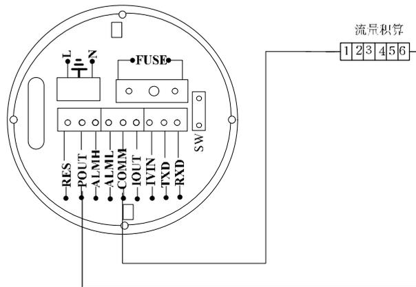
图 4.4.2 (c) 电子计数器接线
