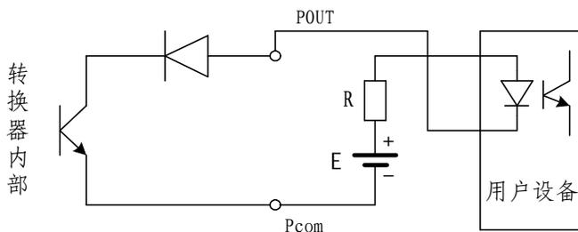
图 4.5(b) 数字量输出接光电耦合器
